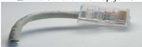
Slika 1. Neoklopljen UTP kabl
